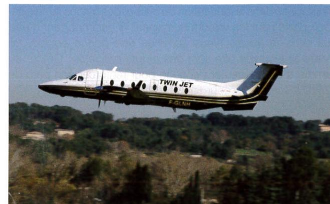
Il s'agit d'un Beechcraft 1900D de 19 places. C'est le seul turbopropulseur permettant aux passagers de se lever dans la cabine, d'où son fuselage agrandi.
